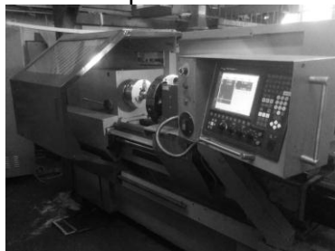
Рисунок 2 – Станок 16A20 с ЧПУ NC201M фирмы «Балт-систем», модернизированный на ТОО ВФ Поиск
