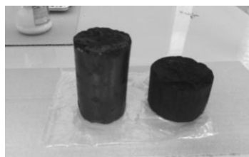
Рисунок 2 – Брикеты из угля разреза Каражыра, покрытые слоем строительной смеси «Грунт Д 75»
