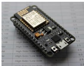
Рисунок 1 – Питание и интерфейс подключения к ПК: Micro-USB
