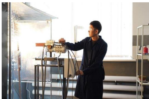
Сурет 1 – Іштен жанатын қозғалтқыштардың иінді біліктердің тозған беттерін қалпына келтіру
