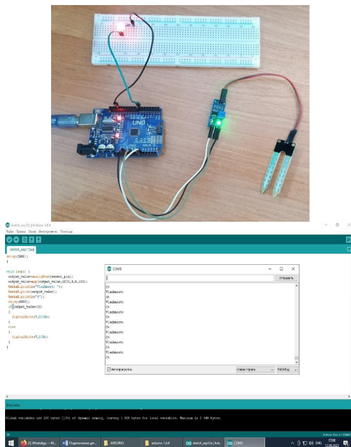
Сурет 2 – Датчиктің жұмысын құрғақ және ылғалды жағдайда тексеру
