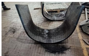
Рисунок 3 – Цельная вальцованная челюсть ковша роторного экскаватора.
