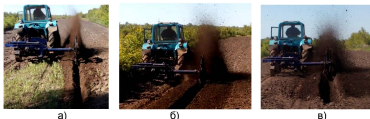
Рисунок 1 – Фрагменты испытаний универсального бороздонарезчика (а – узкая борозда ( \alpha=90^\circ ), б – средняя борозда ( \alpha=85^\circ ), в – широкая борозда ( \alpha=80^\circ ))
