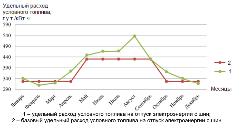
Рисунок 2 – Расход условного топлива на отпуск электроэнергии с шин
