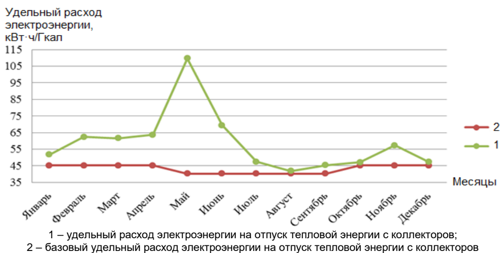
Рисунок 5 – Расход электроэнергии на отпуск тепловой энергии с коллекторов
