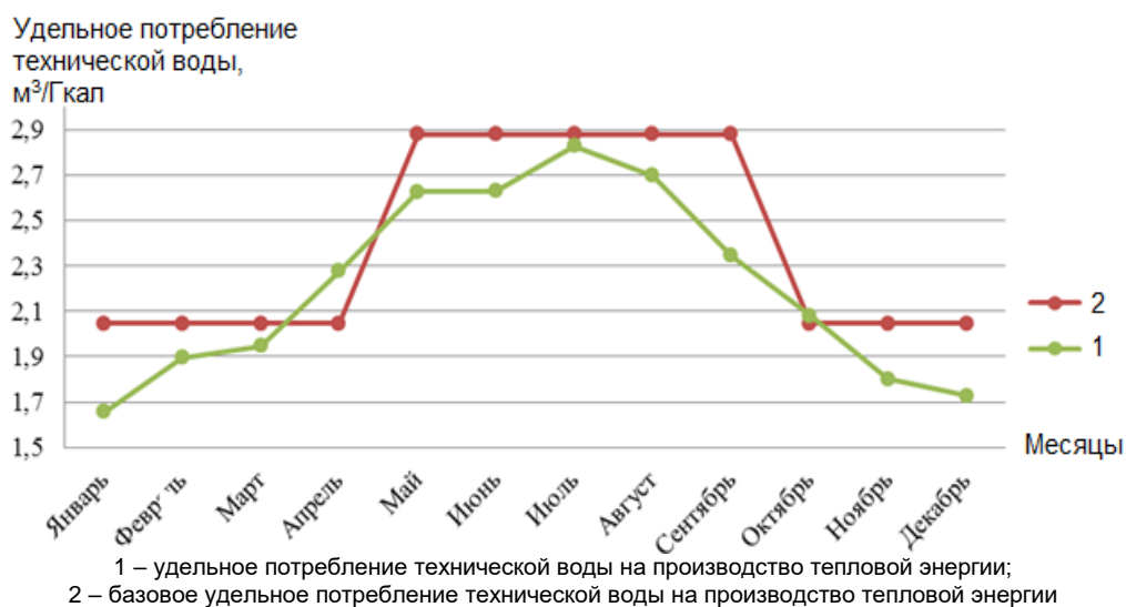
Рисунок 8 – Потребление технической воды на производство тепловой энергии
