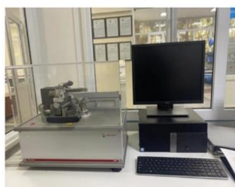
Рисунок 1 – Трибометр и схема метода «шар на диске», используемая для испытаний
