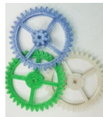
Рисунок 2 – Модели деталей в натуральную величину напечатанные на 3D принтере
