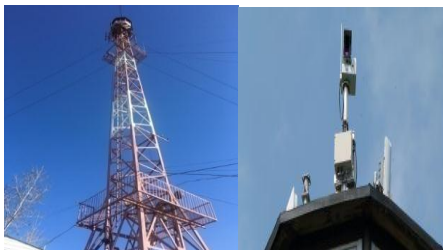
Рисунок 1 – Пожарно - наблюдательная вышка с оптико - сенсорной системой
