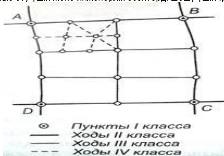
1-сурет. I-IV кластық нивелирлік тораптардың құрылу сұлбасы
