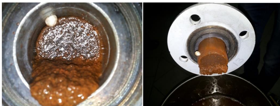
Рисунок 4 – Гелевый скребок АА-ПВП на выходе из модельного нефтепровода
