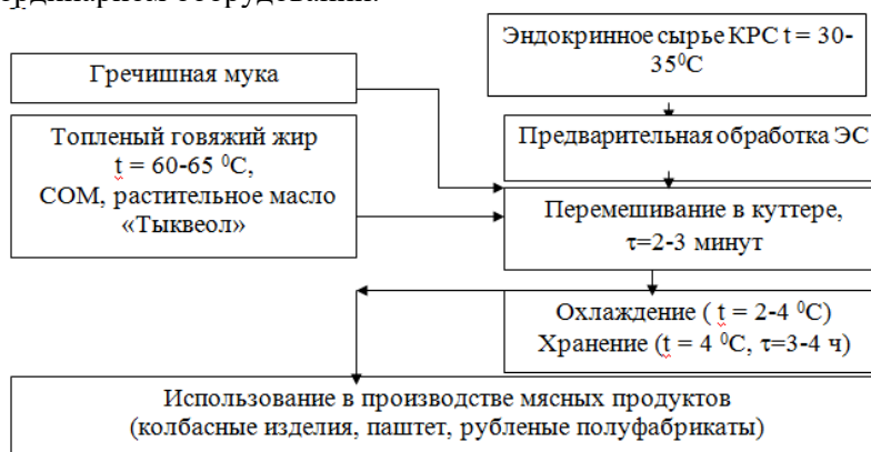
Рисунок 2 – Технологическая схема производства биодобавки
