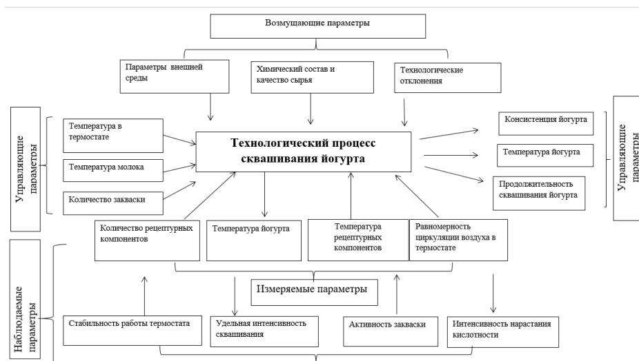
Рисунок 1 – Параметрическая схема технологического процесса сквашивания йогурта
