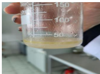
Рисунок 1 – Гидролиз коллагена с добавлением сульфата аммония без охлаждения
