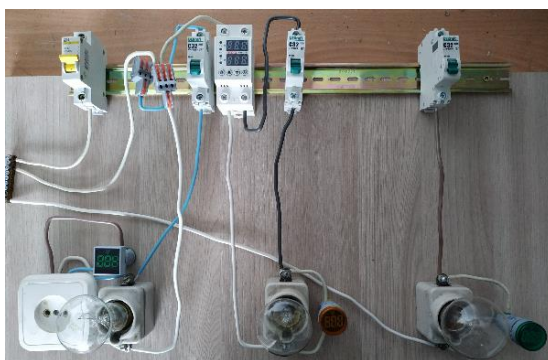
Рисунок 2 – Стенд трехфазной сети с возможностью обрыва нулевого провода
