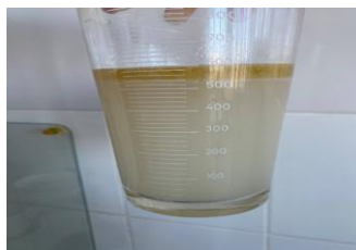
Рисунок 2 – Гидролиз коллагена с добавлением сульфата аммония с применением криосохранения
